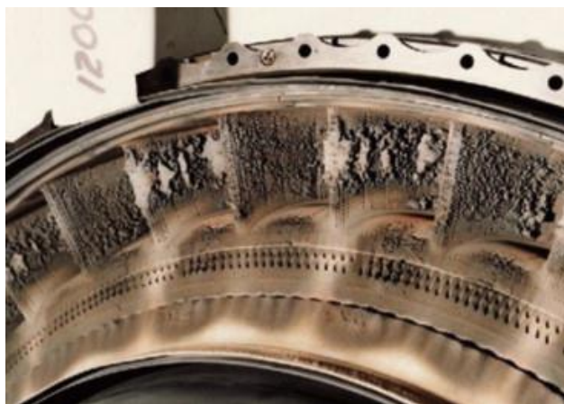
Abbildung 2: Akkumulation vom Material auf den Leitschaufeln (Moody, 1982)
